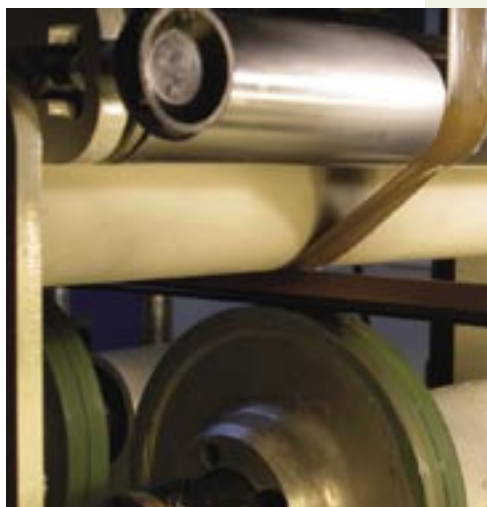
Para ventanas de aluminio y plástico con aspecto característico de madera auténtica el método de producción óptimo es el recubrimiento con lámina exterior resistente a la intemperie. En la foto: una máquina revestidora de perfiles.
